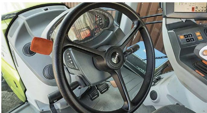
Die Parkposition am Wendehelb sollte auch die Anhängerbremse ansteuern. Außerdem sorgte ein defektes Magnetventil im Getriebe einmal für eine Fehlermeldung.
