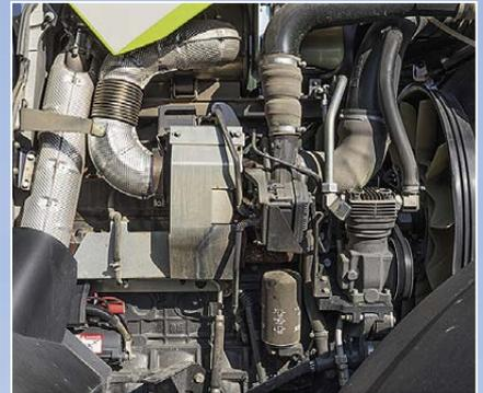
Das Wärmeschutzschild am Turbolader wurde im Rahmen einer Sonderinspektion umgebaut.
