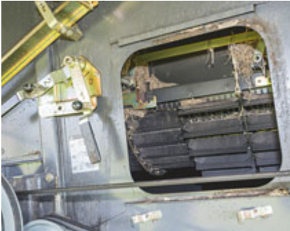
Der Abscheiderrotor hat im vorderen Bereich Abdeckklappen, die manuell verstellt werden können.
