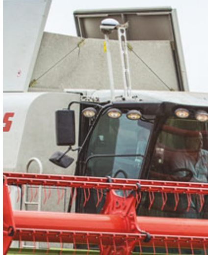
Zusammen mit dem Tankdeckel wird der „Antennenmast“ hochgefahren. Der Empfang ist gut, die Kollisionsgefahr am Waldrand aber groß.
